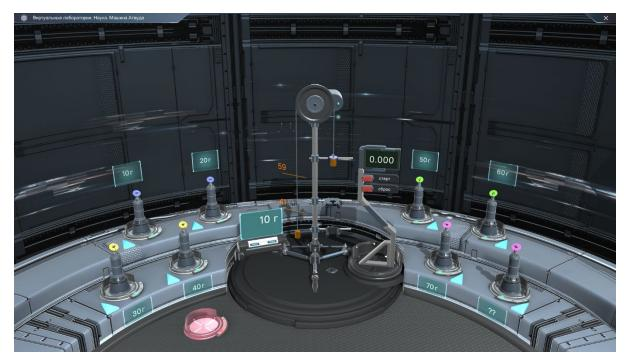
**Машина Атвуда** — трехмерная модель реальной машины Атвуда, которая полностью повторяет структуру, строение и внешние свойства реального аналога. Трехмерная модель имеет логику поведения, повторяющая логику реального объекта.
